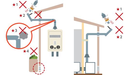
煙突のはずれや煙突に巻いてある断熱材に穴があいていないか、シミがないかを点検してください。異常を見つけた場合は、使用を中止し、ニチガスまでご連絡ください。点検口がない場合は設置をお願いします。
