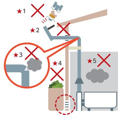
煙突のはずれや煙突に巻いてある断熱材に穴があいていないか、シミがないかを点検してください。異常を見つけた場合は、使用を中止し、ニチガスまでご連絡ください。点検口がない場合は設置をお願いします。
